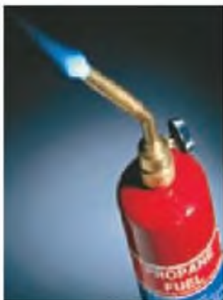
▲ Figura 3.7 El propano arde en aire. El propano líquido (C 3 H 8 ) se evapora y se mezcla con el aire cuando escapa a través de la boquilla. La reacción de combustión de C 3 H 8 y O 2 produce una flama azul.
